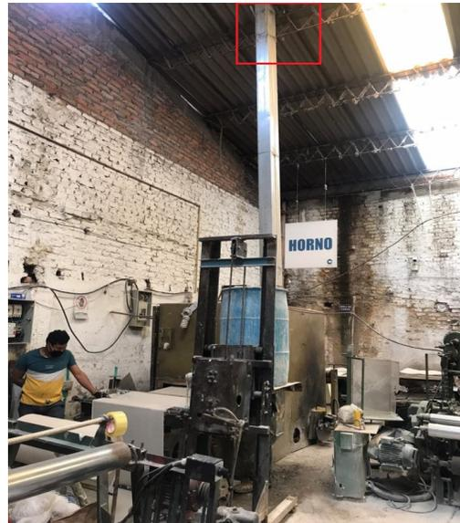
**Fotografía No 3.** Horno de secado junto con ducto de descarga
